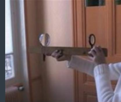
**En Term : Notion et contenu :** Modèle optique d'une lunette astronomique avec objectif et oculaire convergents.
