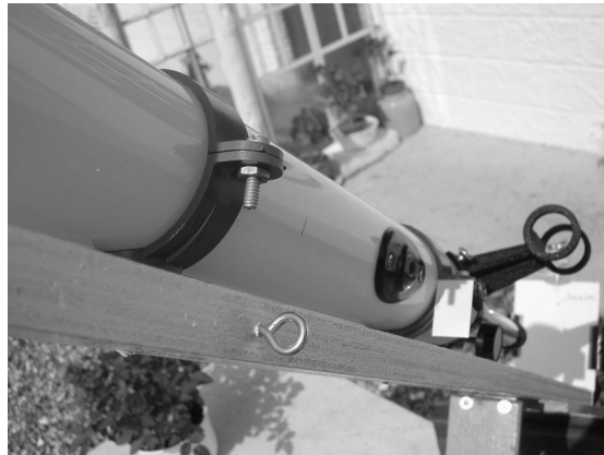
3 - Visée du Soleil avec l'ombre d'une vis.
