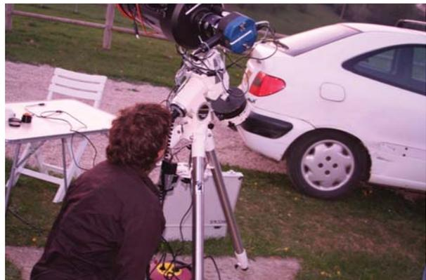
*Fig.3. Étape importante : la mise en station.*
