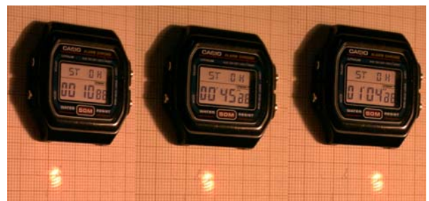
Figure 3 : Les photos successives montrant le spot et le chronomètre. On peut mesurer ainsi l'accélération produite par une sphère attractive.
